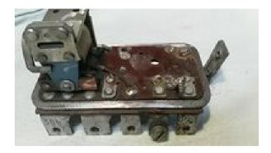
Der Kfz-Regler wird zerlegt, nur das Gehäuse mit der Elektronik wird verwendet. Die Anschlussfahnen werden gekürzt und verzinnt. Zum besseren Löten kann man Lötfahnen auf die Anschlüsse crimpen oder festlöten.
